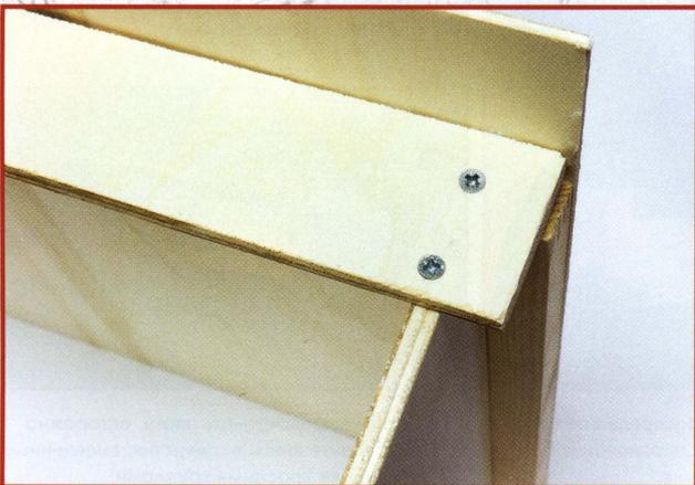
**5** С помощью саморезов прикрепите фанерные полоски к каждой опоре, как показано на снимке.
