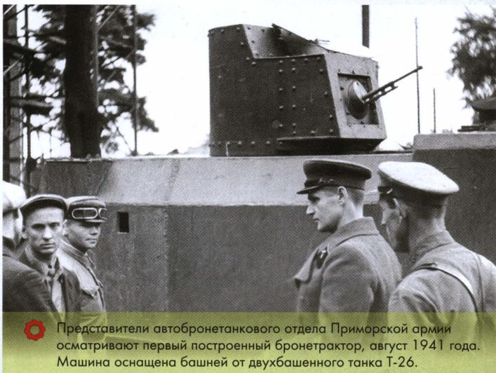
Представители автобронетанкового отдела Приморской армии осматривают первый построенный бронетрактор, август 1941 года. Машина оснащена башней от двухбашенного танка Т-26.
