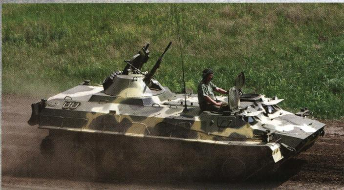
Транспортер-тягач МТ-ЛБ М1А7, вооруженный 12,7-мм и 7,62-мм пулеметами и 30-мм гранатометом. Машина оснащена двигателем мощностью 310 л.с.
