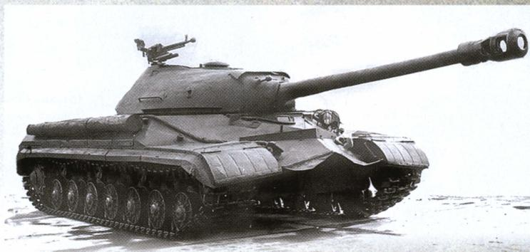
Общий вид танка Т-10. Хорошо видна зенитная установка 12,7-мм пулемета ДШК, на правом борту уложено бревно для самовытаскивания.
