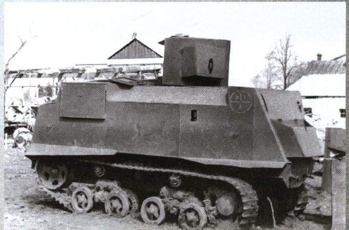
Бронетрактор, построенный в Одессе на шасси тягача СТЗ-НАТИ. Башня изготовлена по типу башни двухбашенного Т-26.
