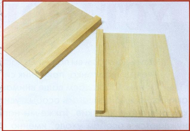
**2** Возьмите дощечки, предназначенные для опор, и прикрепите к ним с одной стороны, как показано на снимке, рейки. Их можно приклеить или привинтить саморезами.
