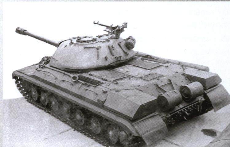
Танк Т-10, вид сзади сверху. Хорошо видны наружные топливные баки, укладка дымовых шашек БДШ-5 и крепление ствола орудия при движении по-походному в положении «пушка назад».
