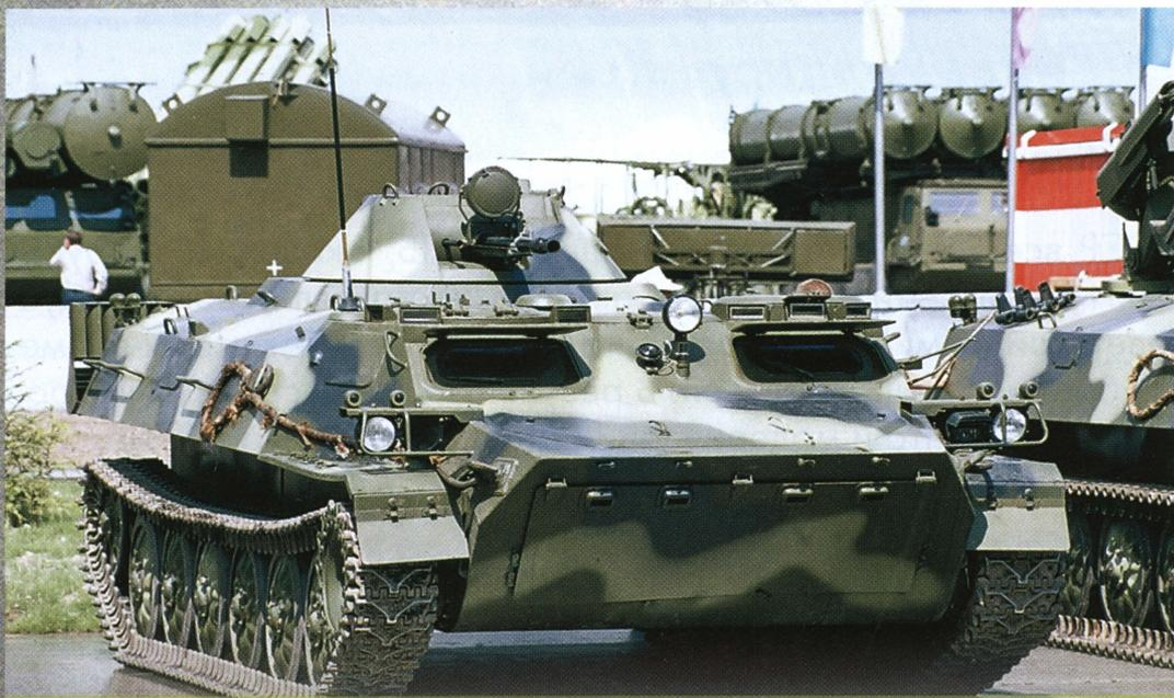
Транспортер-тягач МТ-ЛБМ 6А, вид спереди. Хорошо видна установка башни от БТР-80 с 14,5-мм и 7,62-мм пулеметами.
