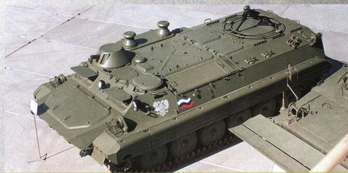
Модернизированный транспортер-тягач МТ-ЛБМ2, вид сверху. На корме корпуса видна установка для гранатомета АГС-17.
