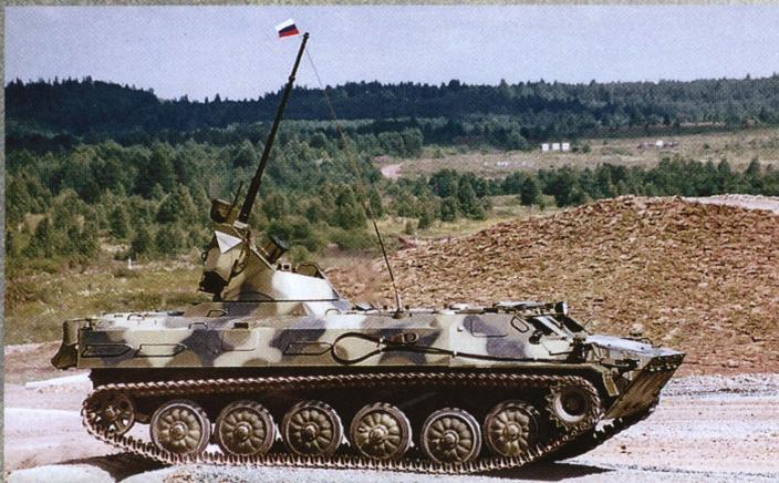
Машина МТ-ЛБМ 6Б во время демонстрации ходовых качеств. 30-мм пушка на максимальном угле возвышения.
